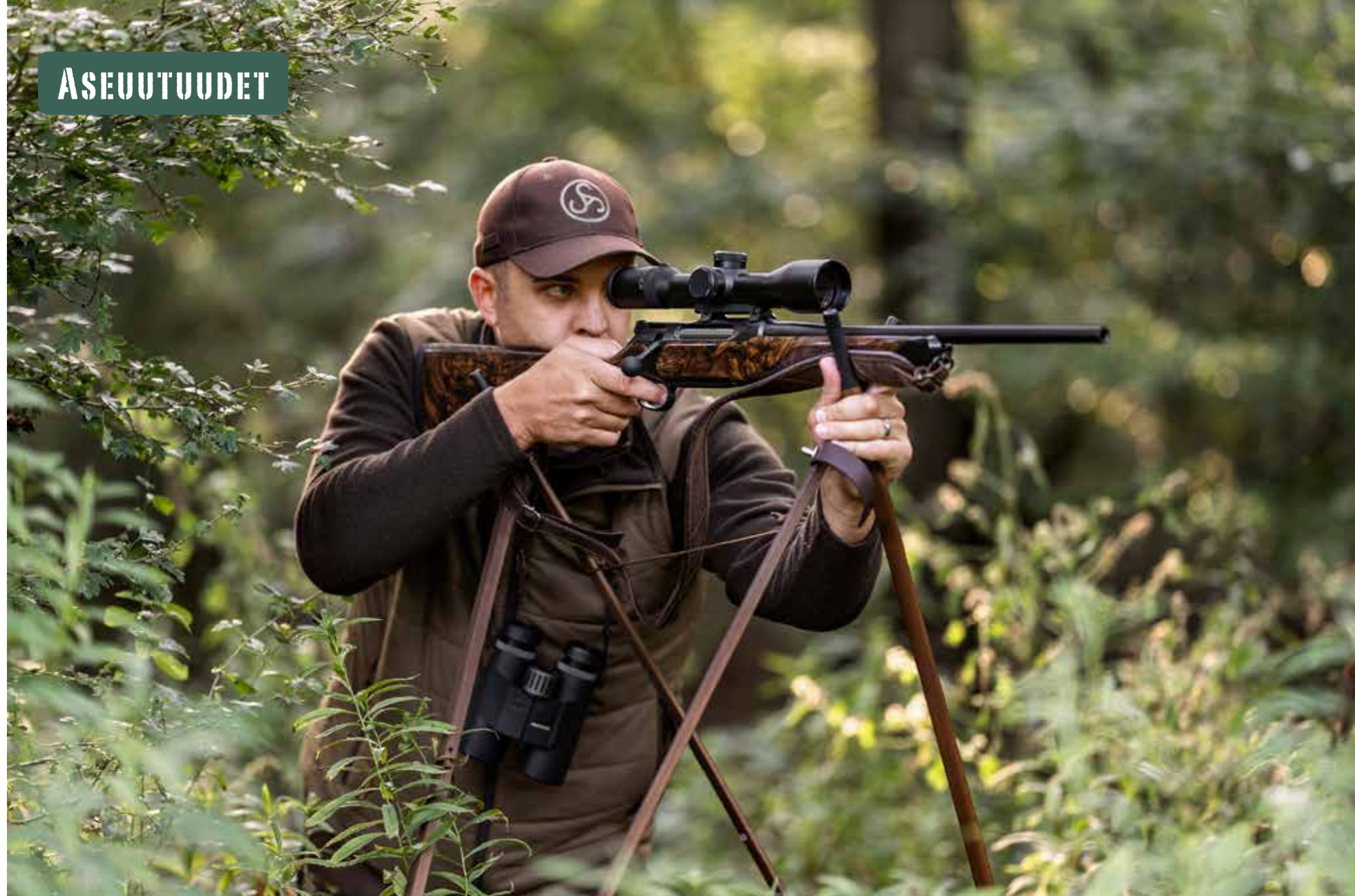
Sauer 505 -pulttilukkokiväärin kylmätaotut vakiopiiput ovat lyhentyneet 51 senttiin.
