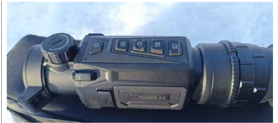
Edelliseen versioon verrattuna tarkennuksen säätö toimii paremmin, helpokäyttöisemmin. Tarkennusta säädetään pyöritettävällä rullakytkimellä, joka on asetettu tähtäimen päälle.
